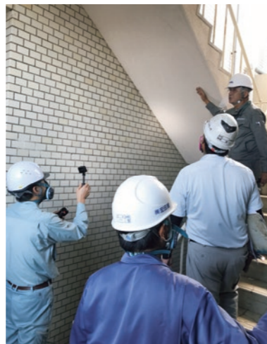
実際の建物でインストラクターから構造・施工方法を交えての調査や採取の具体的な方法を説明します。見落としやミスジャッジをしないポイントを解説。
